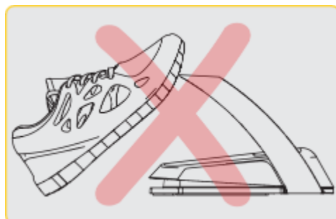
Aktivační pedál je vybaven ochranným krytem, který zabraňuje náhodnému spuštění laseru. Na ochranný kryt nešlapejte, protože by mohlo dojít k náhodnému poškození aktivačního pedálu.
